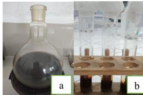
Gambar 1. Preparasi Ekstrak Etanol Daun Jambu Biji a) Ekstrak Kental Hasil Proses Evaporasi Menggunakan Rotary Evaporator; b) Larutan Ekstrak yang telah Diencerkan dengan DMSO pada Konsentrasi 25%, 35%, dan 45% untuk Uji Antibakteri
